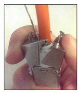
Schließen Sie die Außenkappe, indem Sie beide Seiten der Außenkappe zusammendrücken, bis es klickt. 6
