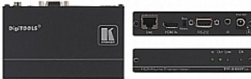
TP-580TXR ist ein HDBaseT Übertrager für 4K UHD HDMI, bidirektionales RS-232 und IR-Signale über Twisted Pair mit erhöhter Reichweite. Er hat Eingänge für HDMI, RS-232 und IR-Signale und wandelt diese in ein HDBaseT Twisted Pair Signal für die Übertragung an den Empfänger TP-580RXR. Die maximale Auflösung des Gerätes ist 4K @60 UHD (4:2:0).
