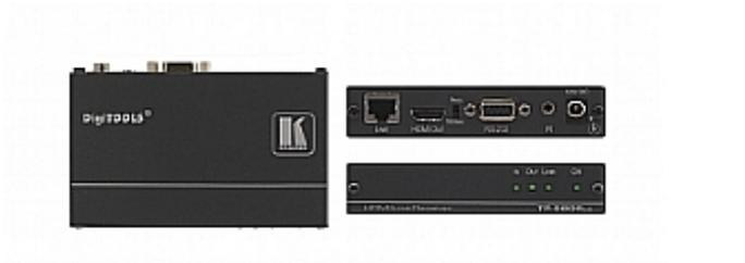
TP-580RXR ist ein HDBaseT Twisted Pair Empfänger für 4K UHD HDMI, bidirektionales RS-232 und IR-Signale mit erhöhter Reichweite. Er hat einen Eingang für das HDBaseT Twisted Pair Signal vom Übertrager TP-580TXR und wandelt dieses zurück in HDMI, RS-232 und IR-Signale. Die max. Auflösung ist 4K @60 (4:2:0).
